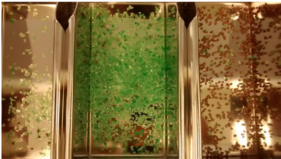
Figura 40 - Separação das partículas de PET (verde escuro e claro) e PVC (marrom) nas melhores condições estudadas.
