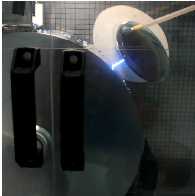
Figura 35 - Descarga elétrica do eletrodo de atração no rolo a uma distância de 2 cm.
