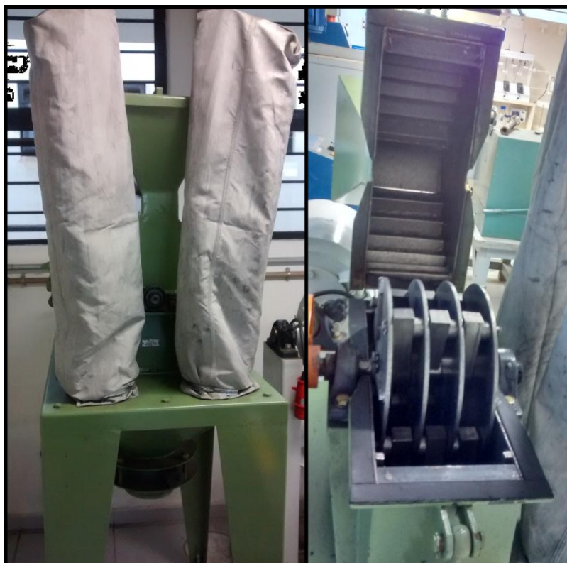
Figura 22 - Moinho de martelos utilizado na cominuição das baterias de íon de lítio.
