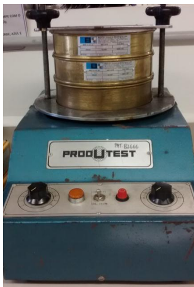
Figura 17 - Peneiras vibratórias utilizadas na etapa de separação granulométrica.
