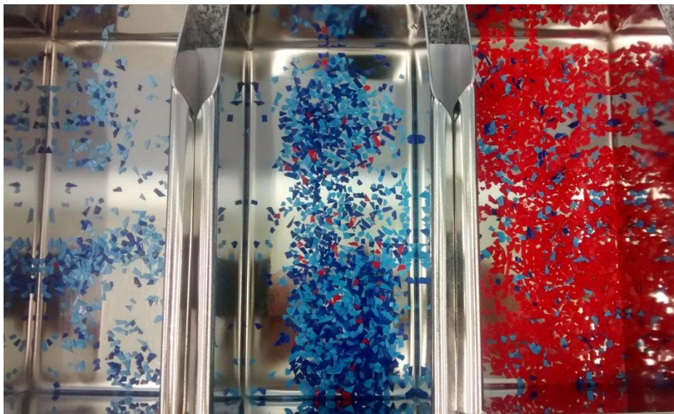
Figura 39 - Separação das partículas de PP (azul escuro e claro) e PEBD (vermelha) nas melhores condições estudadas.
