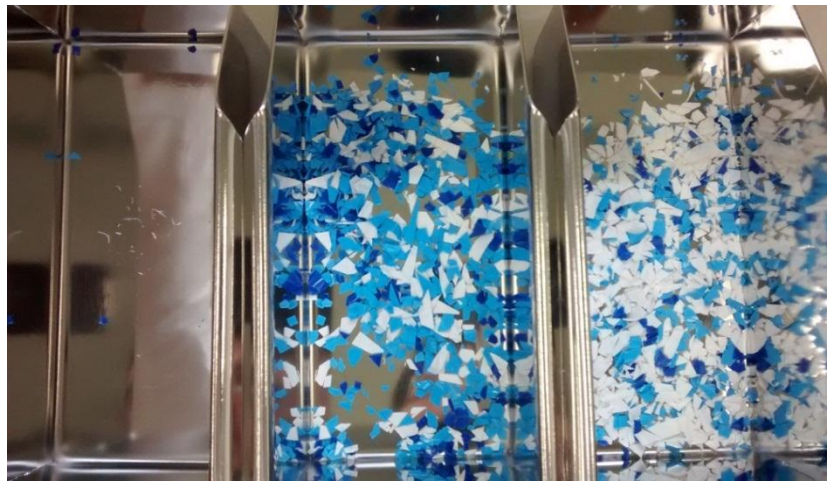
Figura 42 - Separação das partículas de PP (azul claro e escuro) e PEAD (branca), sem tribocarregamento e após o processo de cominuição em moinho de facas com malha de 5 mm.
