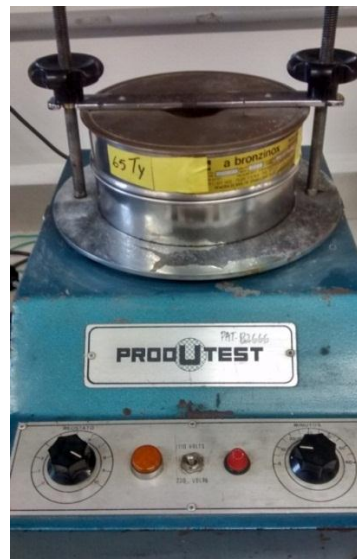
Figura 23 - Peneira vibratória utilizada na etapa de separação granulométrica.
