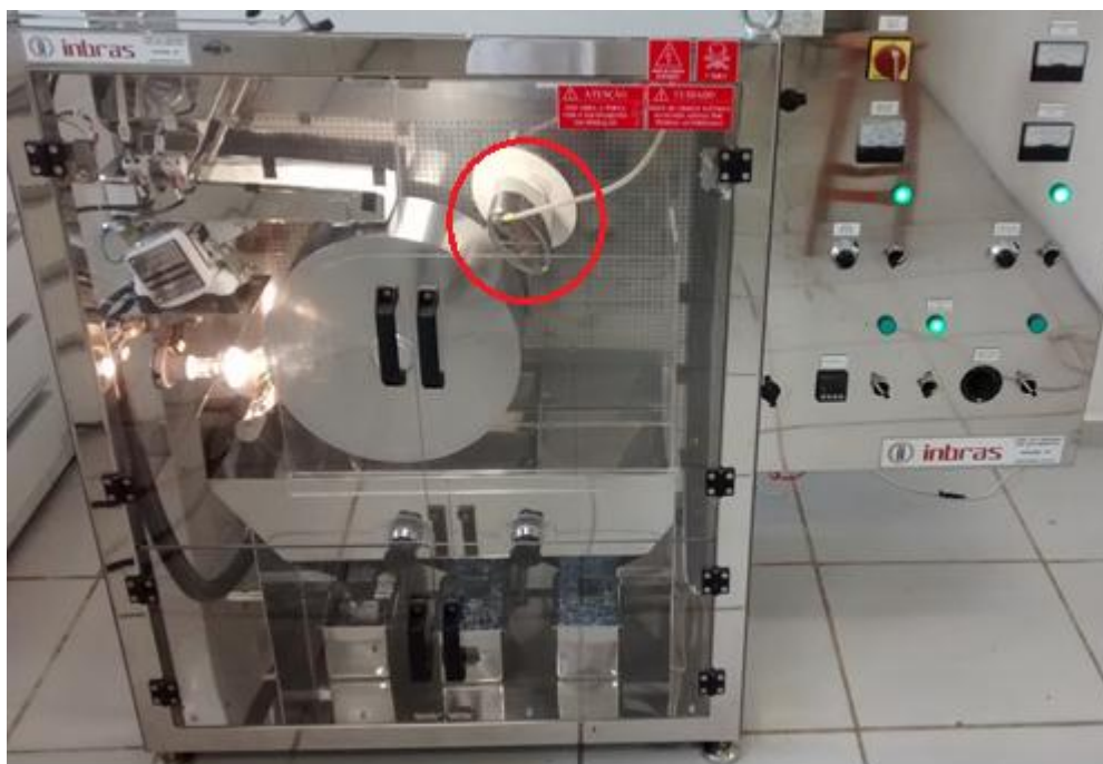
Figura 18 - Separador eletrostático tipo rolo configurado apenas com o eletrodo de atração.
