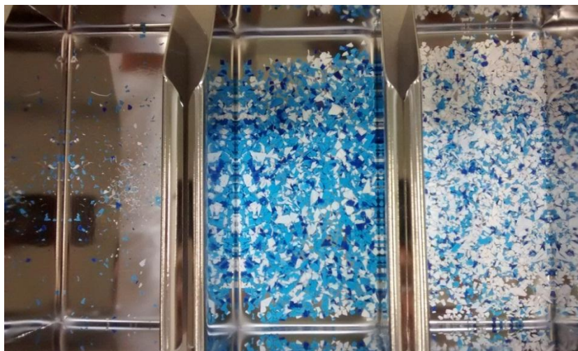
Figura 42 - Separação das partículas de PP (azul claro e escuro) e PEAD (branca), sem tribocarregamento e após o processo de cominuição em moinho de facas com malha de 5 mm.
