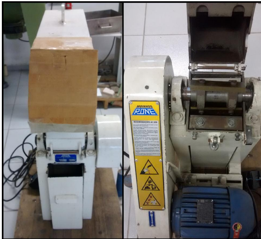
Figura 16 - Moinho de facas utilizado na cominuição dos materiais poliméricos.
