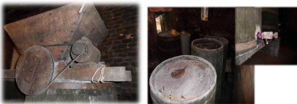
Imagem 5 – Equipamentos e instalações na Propriedade VIT 5 (a esquerda desengaçadora de uva e a direita recipientes de armazenamento do vinho)
