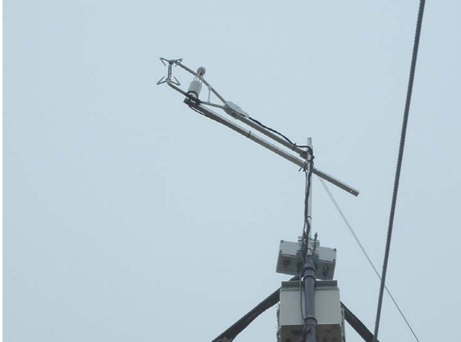
**Figura 5** – Sistema de covariância de vórtices (*eddy covariance*): anemômetro sônico e analisador de gás de caminho aberto.
