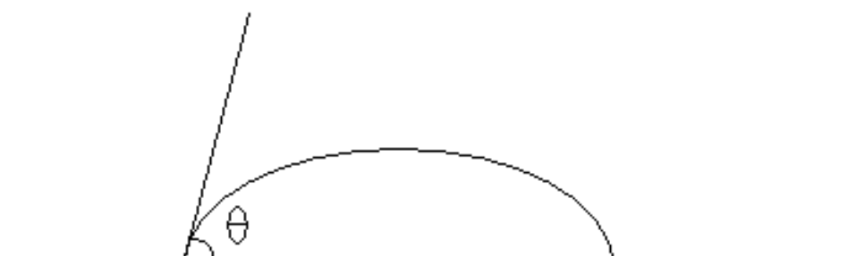
Figura 2: Definição de ângulo de contato aparente, \theta .
