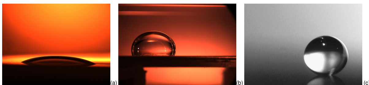
Figura 7: (a) Superfície hidrofílica; (b) Superfície hidrofóbica; (c) Superfície superhidrofóbica.
