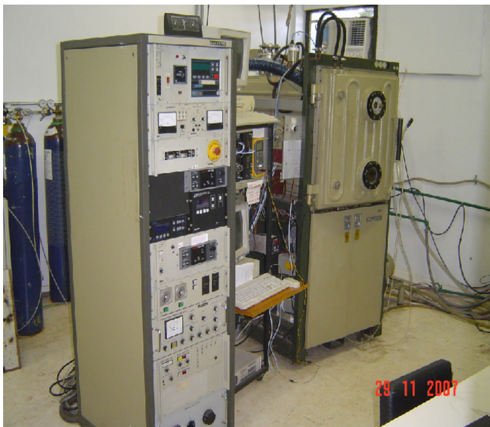
FIGURA 10 - Magnetron sputtering do LMMM. A torre da esquerda abriga os controladores de vácuo, fluxo de gás e fontes, enquanto a torre da direita é a câmara de vácuo onde as amostras são depositadas.
