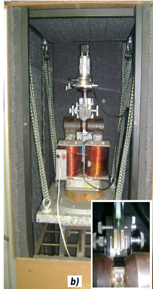
FIGURA 18 - a) esquema de funcionamento do AGFM, b) foto do AGFM usado no LMMM.(figura extraída da ref.[12])
