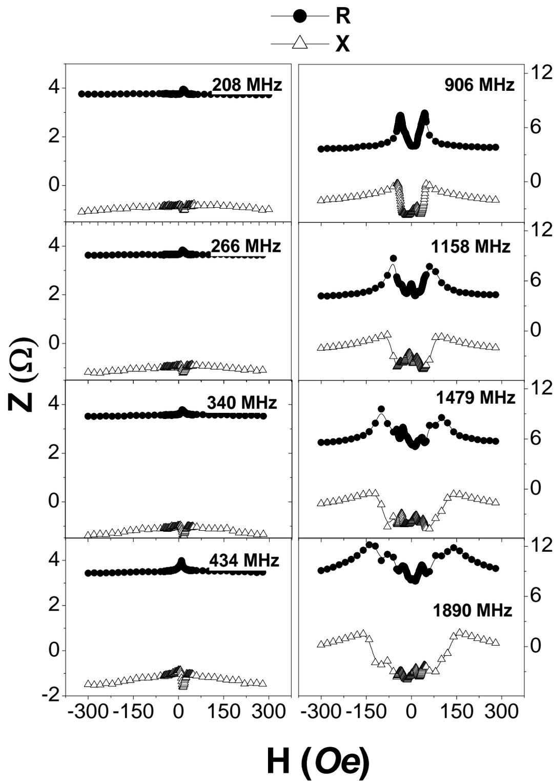
**Figura 4-10** Comportamento da parte real (R) e da parte imaginária (X) da impedância da amostra S2 (Finemet 5000 Å).
