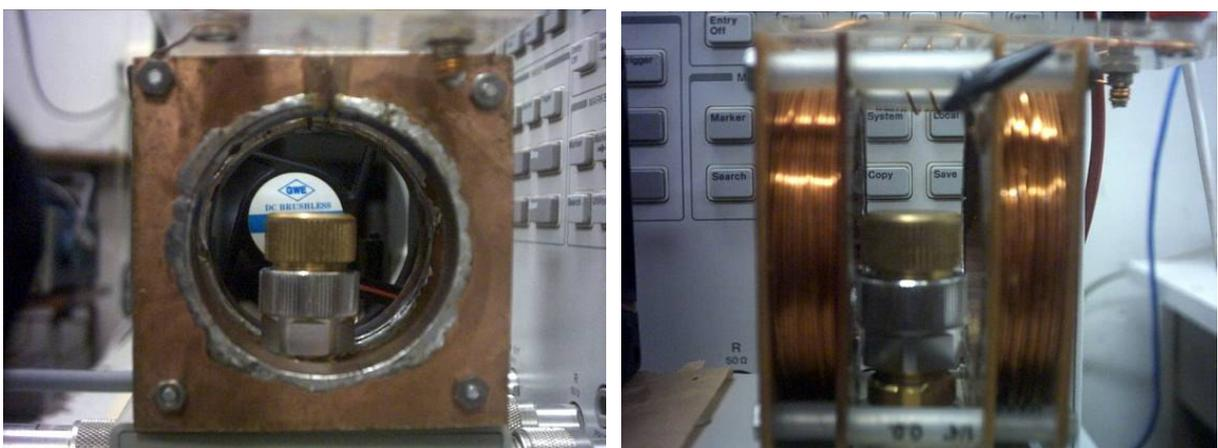
**Figura 3-13** – Fotos da bobina de Helmholtz e o conector APC-7 com a amostra montada.
