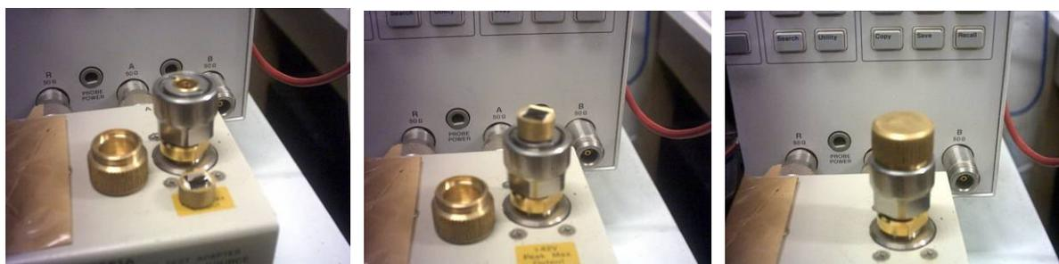
**Figura 3-15** – Seqüência de montagem do porta amostras no conector APC-7.
