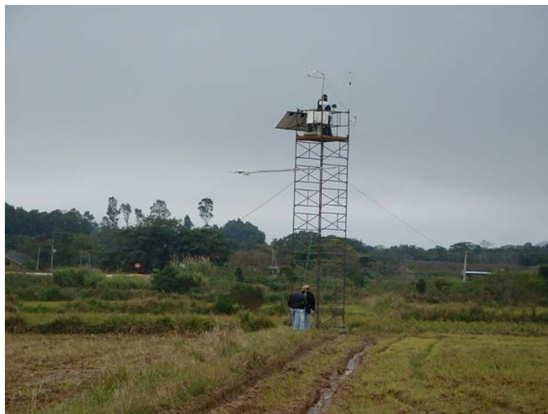
Figura 3.1. Foto da torre Micrometeorológica do Projeto CT-HIDRO em Paraíso do Sul.
