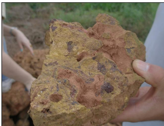
Figura 17: Crosta laterítica ferruginosa em superfície aplainada constituída por solos argilo-arenosos de tonalidade avermelhada.
