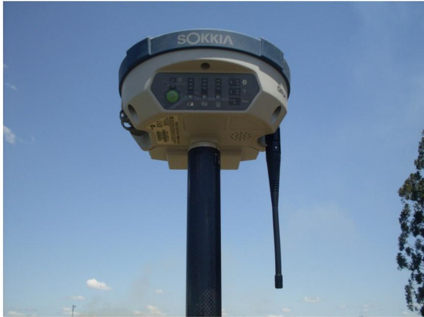
**Figura 6** – Receptor GNSS modelo GRX1 da Sokkia.
