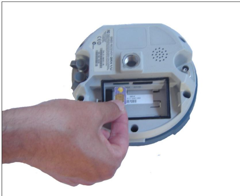
**Figura 9** – Colocação do *SIM Card* (chip) no modem GSM do receptor GRX1
