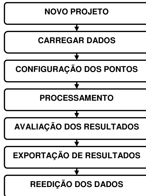
Figura 02 - Fluxograma de atividades realizadas durante o processamento dos pontos levantados com o aparelho GPS ProMarck2
