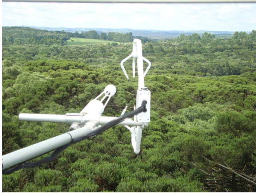
Figura 3.3: Vista de cima da torre micrometeorológica, com o sistema de “ eddy covariance ” em primeiro plano, e, ao fundo, o topo da floresta.
