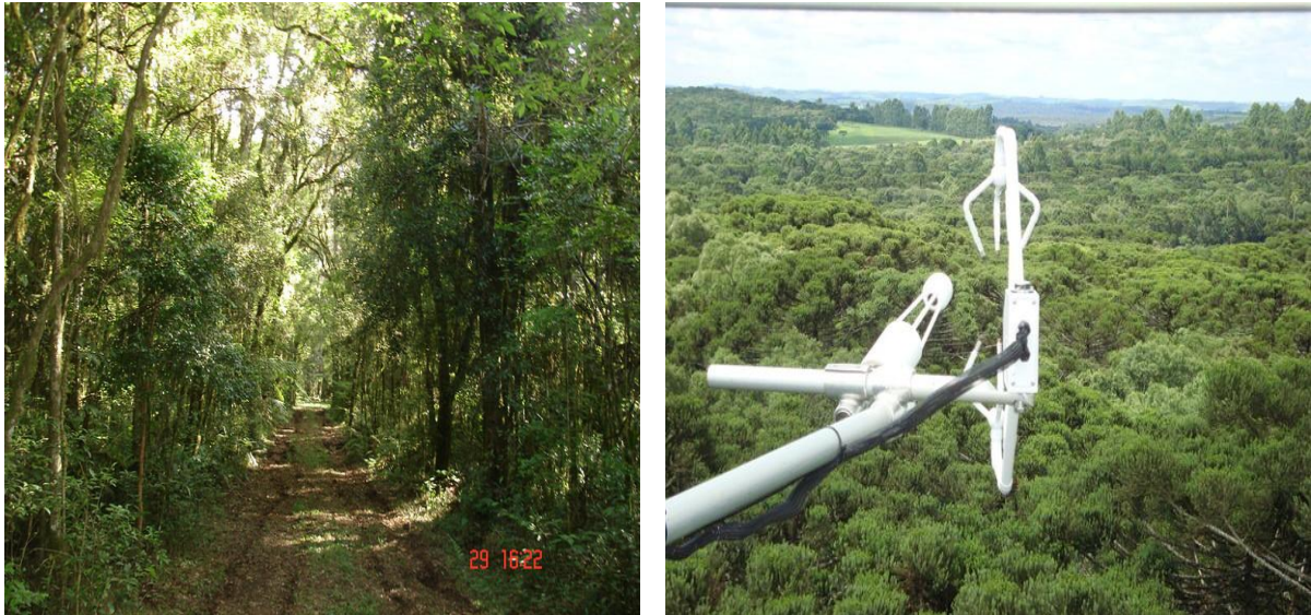
Figura 2.1 – Sítio São João do Triunfo. (a) vegetação próxima à torre micrometeorológica e, (b) sistema Eddy Covariance em primeiro plano, e, ao fundo, o topo da floresta. Fonte: Oliveira (2011).
