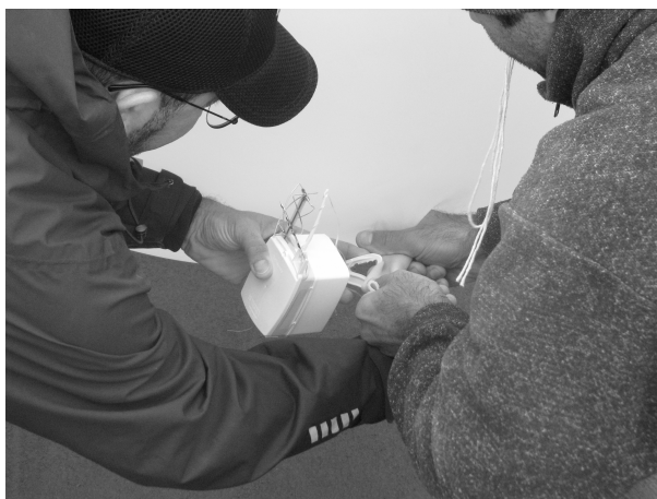
Figura 2.5 - Etapa de fixação do instrumento no balão meteorológico.
