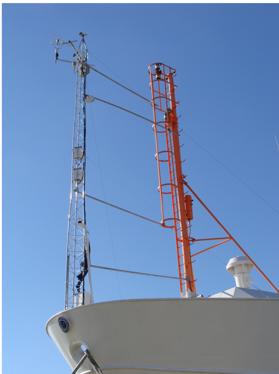
Figura 2.4 - Torre micrometeorológica instalada na proa do NHo. Cruzeiro do Sul.
