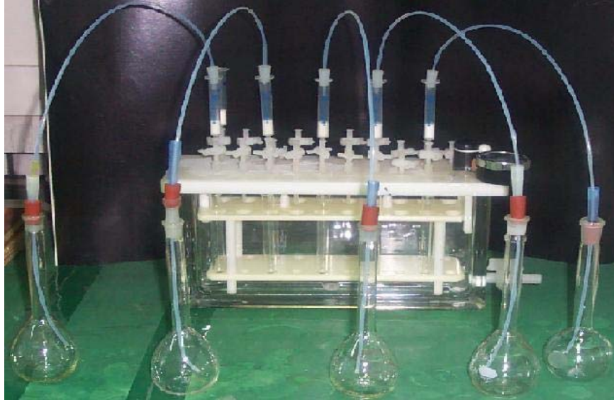
Figura 6. Sistema SPE utilizado para pré-concentração das amostras.
