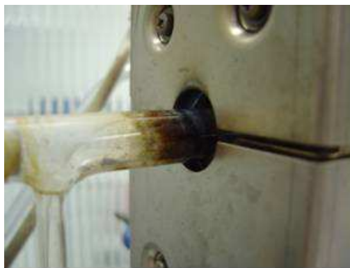
Figura 18. Foto da saída do reator, onde pode ser observado o acúmulo de material não decomposto, na região escura do tubo de quartzo, entre o forno e o condensador. Condições de piroidrólise: tempo de reação de 13 min; massa de amostra de 300 mg; temperatura entre 950 a 1000 °C.
