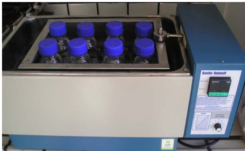
Figura 5. Banho termostatizado com agitação empregado no procedimento de extração do Método 1.
