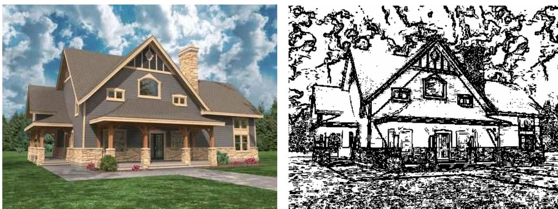
Figura 14 – Imagem (esquerda) *Bitmap* de 24 bits, e imagem (direita) depois do processo de detecção de bordas e limiarização.
