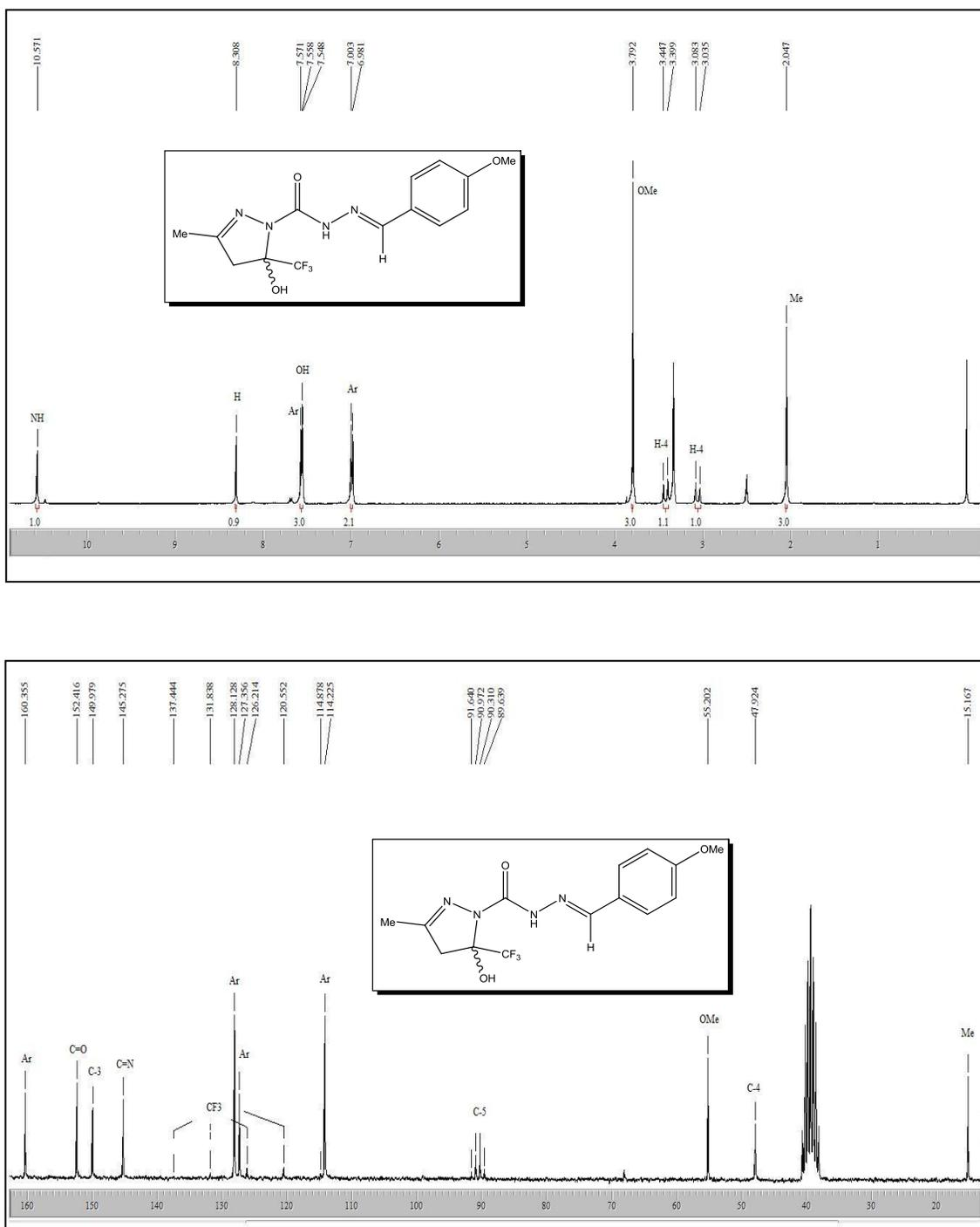
**Figura 37-** Espectro de RMN  $^1\text{H}$  a 400,13 MHz e RMN  $^{13}\text{C}$   $\{^1\text{H}\}$  a 50,32 MHz de 1-(3-metil-5-hidróxi-5-trifluormetil-4,5-diidro-1H-pirazol-1-il)-2-(4-metoxibenzilideno)carboidrazida (**3g**), registrado em DMSO- $d_6$ .
