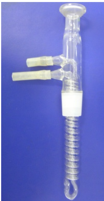
Figura 4. Condensador de refluxo tipo serpentina adaptado para FMIC.
