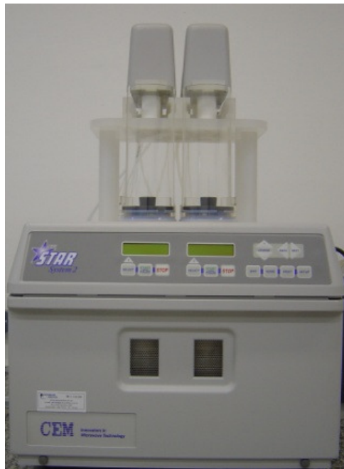
Figura 2. Forno de micro-ondas utilizado para decomposição por FMAWD e FMIC.
