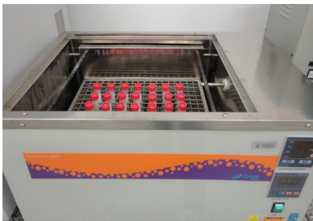
Figura 2. Equipamento utilizado para aquecimento e agitação na solubilização com TMAH.
