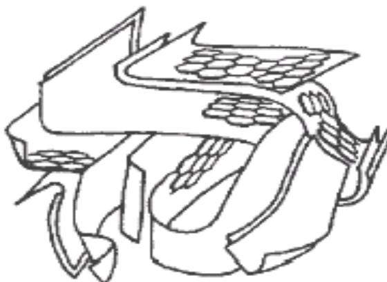
**Figura 14.** Esquema da estrutura para carvões proposta por **Stoeckli** (adaptada de **Wagner**<sup>3</sup>).
