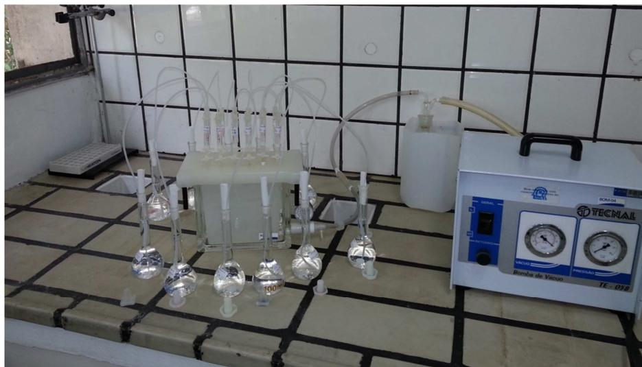
**Figura 5** – Sistema de Extração em Fase Sólida (SPE)
