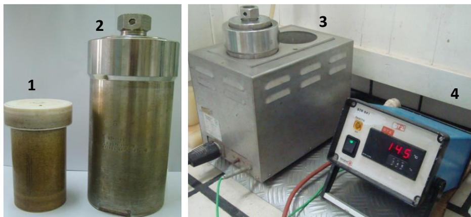
Figura 12 – Sistema Berghof empregado na hidrólise ácida da casca de arroz. Componentes: 1) vaso de teflon; 2) morteiro de aço inox; 3) sistema de aquecimento/resfriamento; 4) controlador de temperatura.
