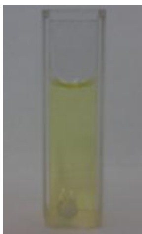
Figura 39 - Cubeta da reação do p NF para demonstrar a coloração amarela intensa, referente ao íon p -nitrofenolato.
