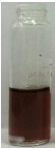
Figura 24 - Dispersão coloidal de triblock1@AuNPs ( C_p = 1,0 mg/mL) com uso do \text{NaBH}_4 em \text{pH} = 7,4
