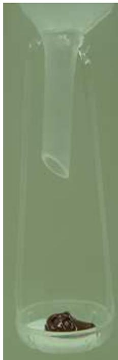
**Figura 12.** Foto de 0,15 g de amostra sobre o disco de papel filtro, na base do suporte de quartzo utilizado.
