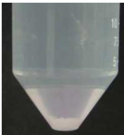
**Figura 20.** Resíduo da decomposição de 1 g de amostra por via seca empregando o procedimento alternativo com HNO<sub>3</sub> e HF.
