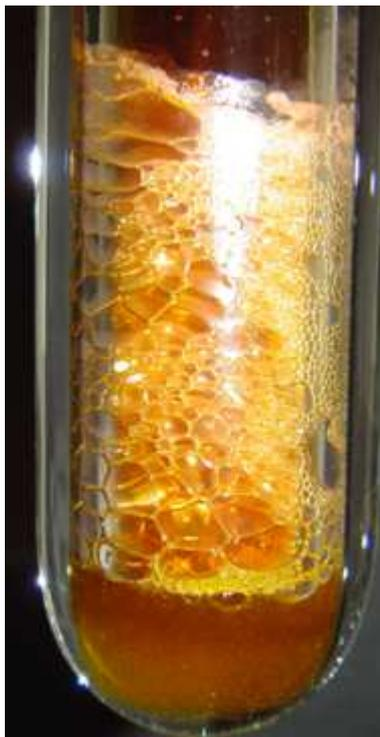
**Figura 15.** Foto da reação de 0,2 g de amostra, instantes após a adição de 6 mL de  $\text{HNO}_3$ .
