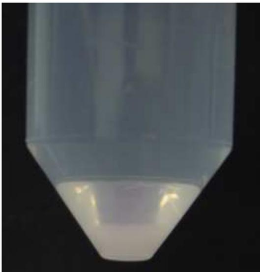
**Figura 16.** Resíduo da decomposição de 0,2 g de amostra por via úmida empregando 6 mL de  $\text{HNO}_3$ .
