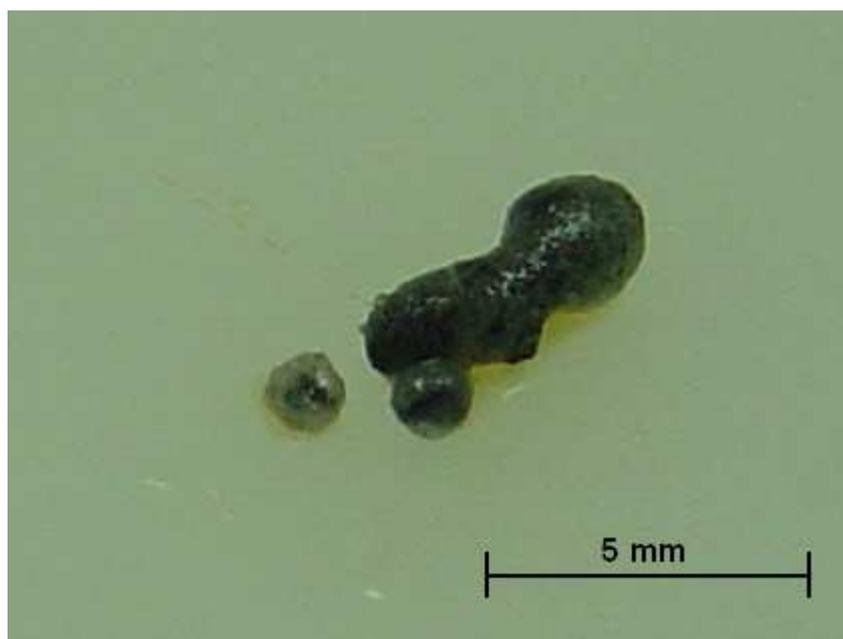
**Figura 13.** Foto do resíduo da combustão de 0,2 g de amostra por combustão iniciada por micro-ondas.
