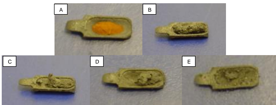
Figura 11. Plataforma de grafite com amostra de ferro aminoácido quelato (5 mg de amostra): (A) plataforma com amostra antes do aquecimento; (B) plataforma com amostra após o ciclo de aquecimento (secagem 120 °C por 30 s, pirólise 800 °C por 30 s e atomização 2400 °C por 8 s); (C) plataforma com amostra após o ciclo de aquecimento com 20 µL de água; (D) plataforma com amostra após o ciclo de aquecimento com 20 µL de ácido oxálico 5% m/v; (E) plataforma com amostra após o ciclo de aquecimento com 20 µL de ácido nítrico 10% v/v.
