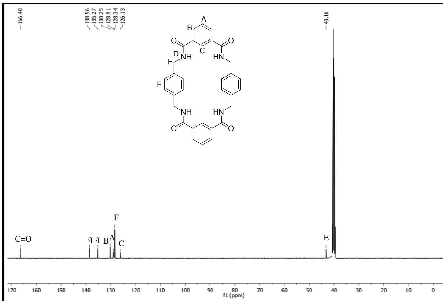
Figura 73. Espectro de RMN de ^{13}\text{C} do composto 1,7,14,20-Tetraaza-2,6,15,19-tetraoxo-3,5,9,12,16,18,22,25-tetrabenzociclohexacosano ( 17 ) em DMSO.
