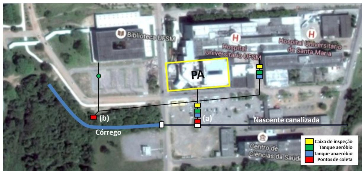
Figura 3 - Representação esquemática sobreposta à imagem de satélite do sistema de esgotos e de tratamento de efluentes do HUSM.
