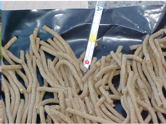
Medição da temperatura de secagem
