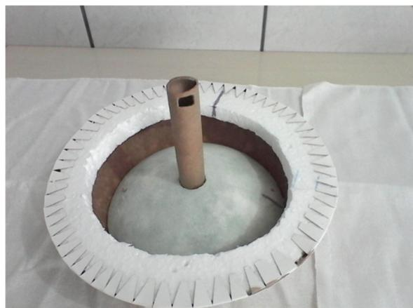
Figura 3.15 – Maquete do tronco do cone do reservatório.
