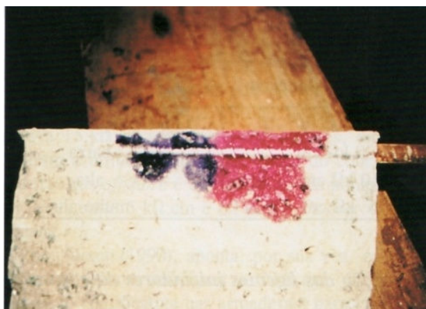
Figura 25. Análise da Carbonatação do Concreto por meio do Emprego dos Indicadores Timolftaleína (azul) e Fenolftaleína (vermelho carmim), em que se vê, na Parte do Concreto de Cobrimento, uma Frente de Carbonatação Incipiente na Região de Aspersão da Timolftaleína (CASCUDO, 2005, p.1090).
