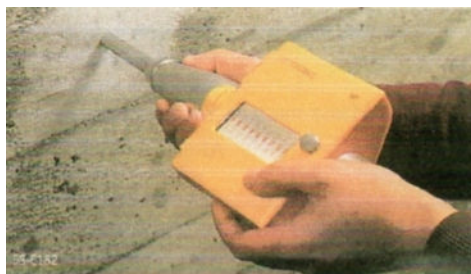
Figura 14. Vista de um esclerômetro de reflexão tipo Schmidt (FIGUEIREDO, 2005, p. 989)
