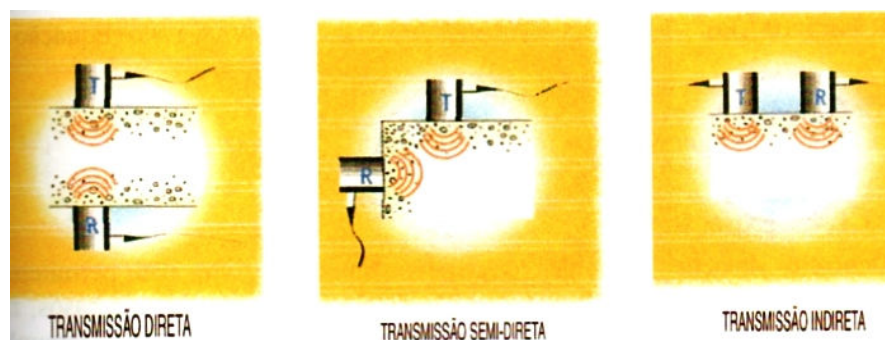
Figura 18. Demonstração dos tipos de transmissão: direta à esquerda, transmissão semidireta ao centro e transmissão indireta à direita (FIGUEIREDO, 2005, p. 993).
