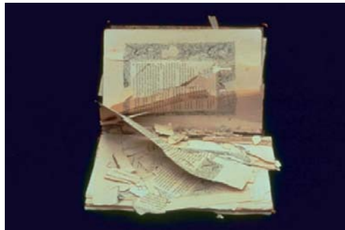
Figura 1 – Fatores internos de degradação. Papel ácido: o suporte torna-se frágil e quebradiço. Fonte: BOJANOSKI, 2012, slide 24
