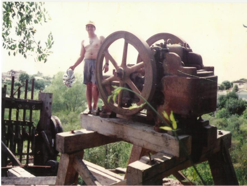
Figura 32 – Máquina utilizada na trituração do ouro. Fonte: Acervo de Zélio Leite.
