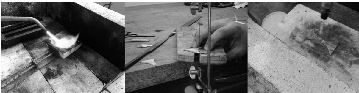
Figura 28 – Processo de fundição corte e solda de uma peça de prata Fonte: autor da dissertação.
