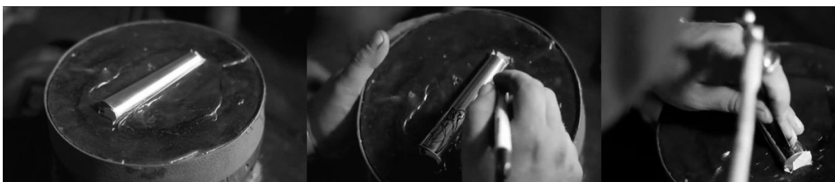
Figura 29 – Prateiro fazendo processo de cinzelado no cabo de uma faca Fonte: Paisanos (2014).
