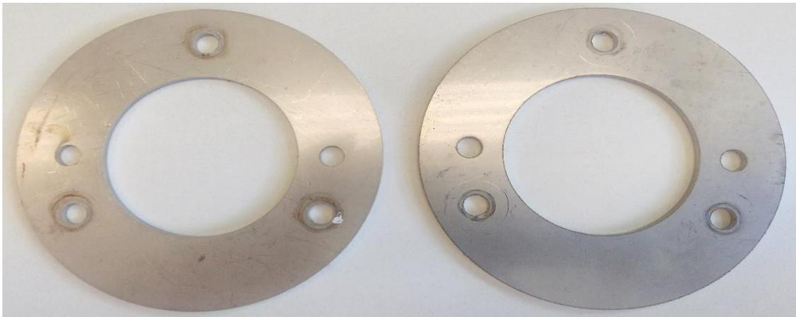
Figura 15. Anilhas de aço inox para fixação da membrana e do adsorvente visando a retenção dos agrotóxicos
