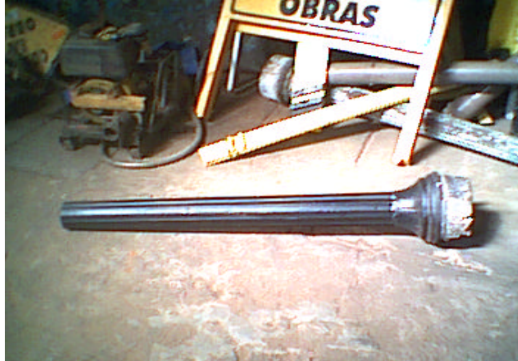
FIGURA 36 – Recuperação de postes de iluminação.
