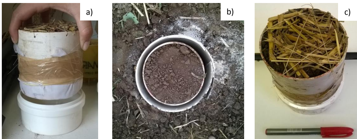
Figura 6 – Microlisímetro, com o tecido fixado com fita adesiva e do copo coletor, em PVC (a), inserido no solo dentro do envelope (b), ML com 4 t ha -1 de resíduo vegetal fixado (costurado) na superfície do microlisímetro (c).
