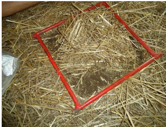
Figura 4 - Coleta dos resíduos vegetais com o quadro amostral (0,30 x 0,30 m).
