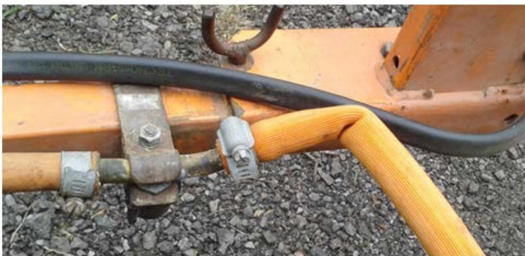
Figura 13: Mangueira responsável pela condução da calda em condição imprópria de trabalho. Fonte: Martini, 2015.
