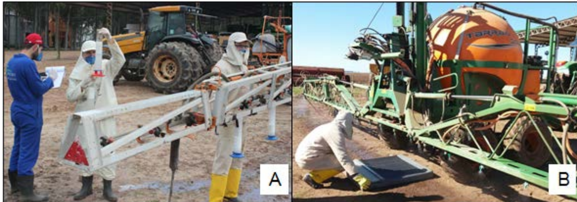
Figura 19: Determinação da vazão (A) e perfil de distribuição das pontas de pulverização (B).
