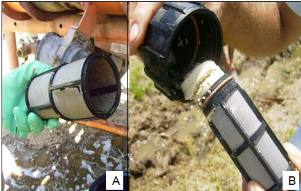
Figura 24: Filtro da bomba danificado (A) e filtro de seção com resíduo (B). Fonte: Dornelles, 2008.
