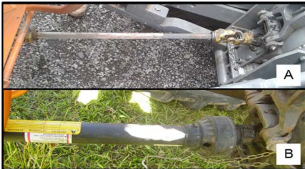
Figura 12: Árvore com junta cardânica sem proteção de segurança (A) e com proteção de segurança (B). Fonte: Bertollo, 2016.
