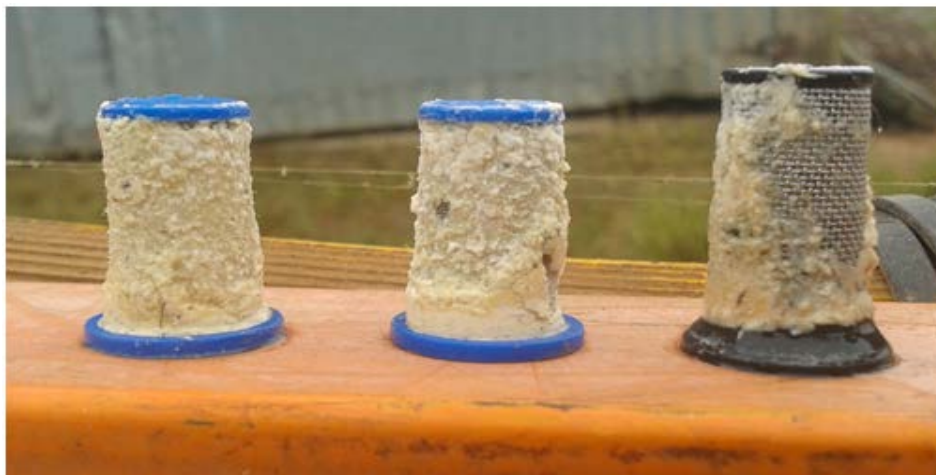
Figura 18: Filtro das pontas de pulverização com resíduos. Fonte: Martini, 2016.
