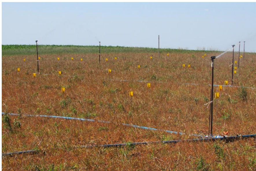
Figura 5 - Determinação do Coeficiente de Uniformidade de Christiansen (CUC).
