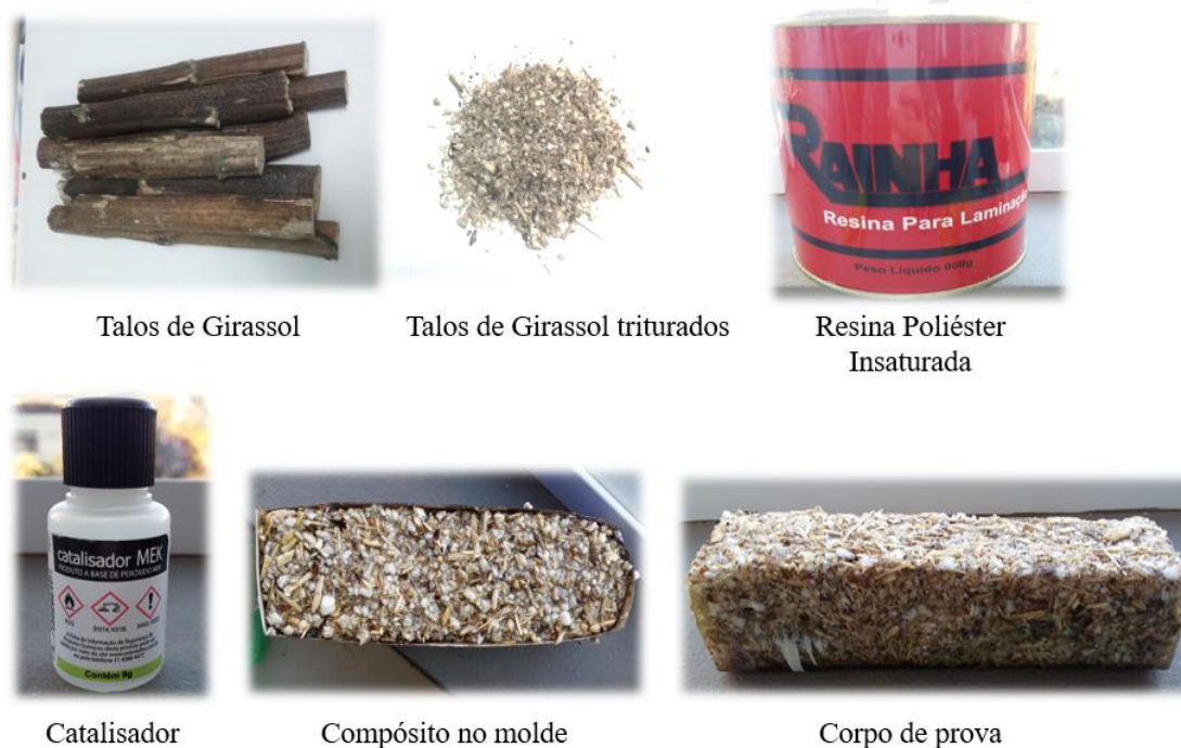
Figura 5 - Materiais usados no desenvolvimento do compósito e dos corpos de prova.
