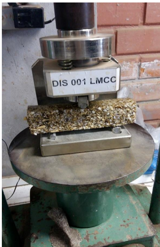
Figura 8 – Equipamento usado para realização do ensaio.
