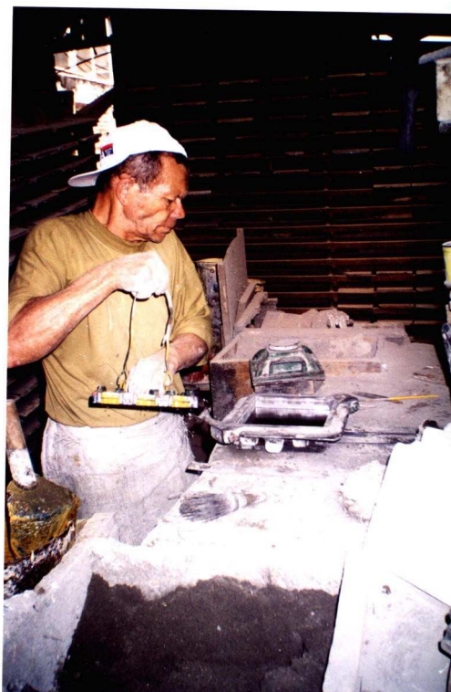
Figura 7 – Mestre ajustando o molde dentro da fôrma. (Acervo pessoal).
