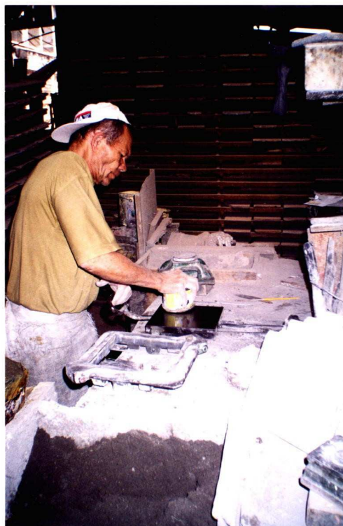
Figura 6 – Mestre ladrilheiro da Ornatos Nossa Senhora da Penha – SP, preparando a base da fôrma. (Acervo pessoal).
