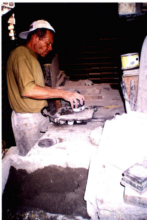
Figura 11 - Mestre espalhando de forma homogênea a camada intermediária. (Acervo pessoal).
