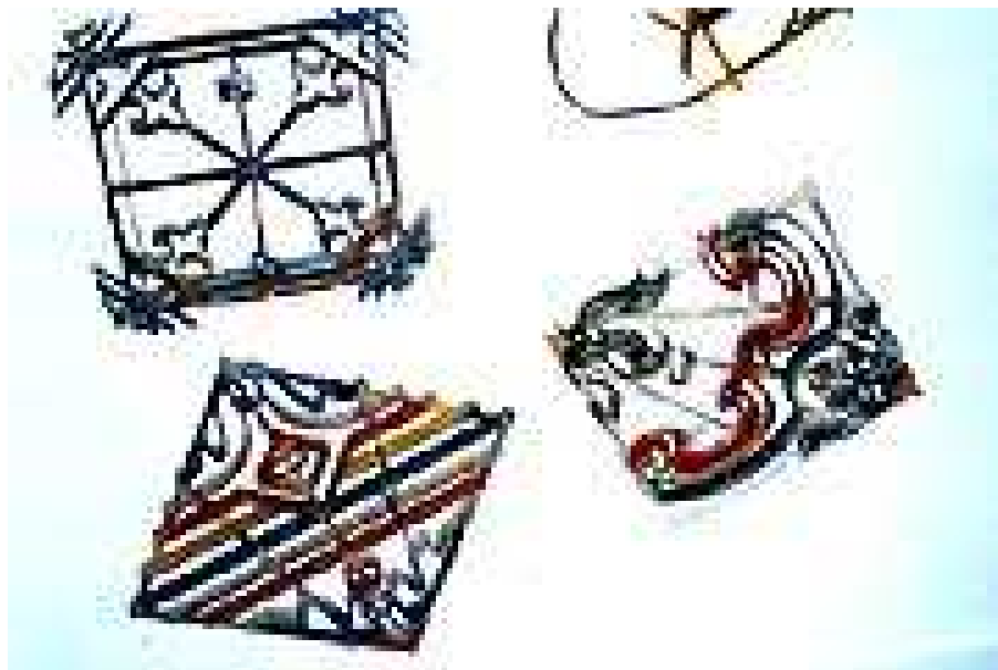
Figura 38 – As ferramentas: moldes feitos em latão por uma pessoa especializada. ( http://www.sampacentro.terra.com.br )
