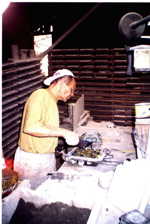
Figura 9 – Mestre ladrilheiro despejando a primeira camada sobre o molde. (Acervo pessoal).
