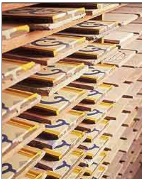
Figura 15 - Depois de desenformadas as peças, o material precisa ficar em repouso por 12 horas. Esta etapa ocupa boa parte do espaço das fábricas, o que obriga muitas delas a trabalharem sob encomenda, evitando assim grande volume de estoque. (MEDEIROS, 2003).
