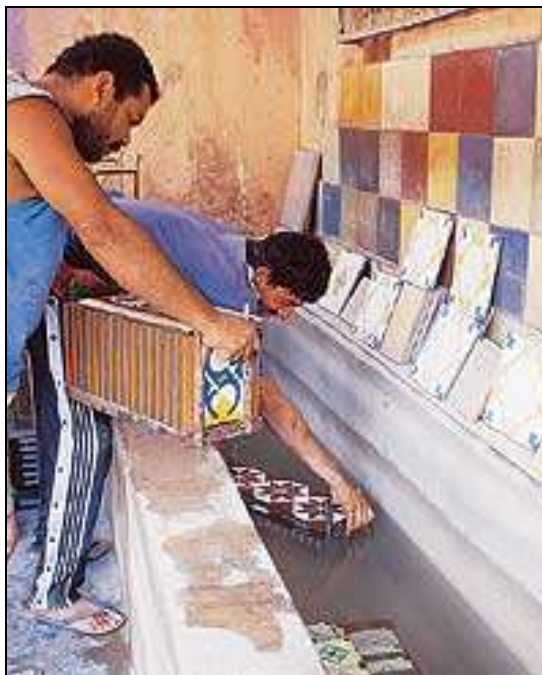
Figura 16- Os ladrilhos hidráulicos recebem este nome pelo fato de ficarem imersos em água após o repouso. Ao contrário dos materiais cerâmicos, dispensam qualquer processo de queima. (MEDEIROS, 2003).
