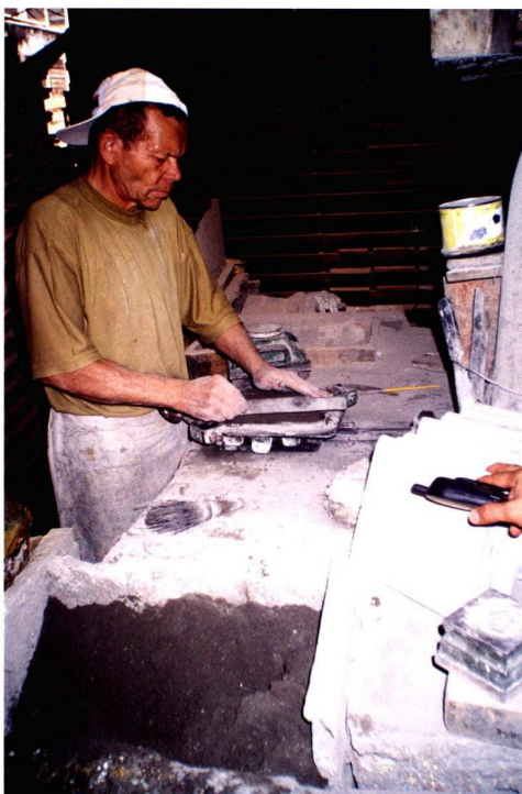
Figura 12 - Última camada ou camada base sendo nivelada com régua para preencher toda a fôrma. (Acervo pessoal).
