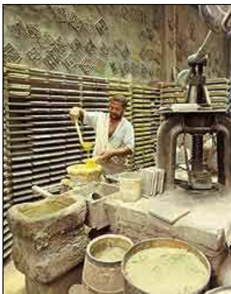
Figura 3 - Na fábrica Dalle Piagge, em São Paulo, trabalhador prepara a tinta para os ladrilhos hidráulicos. Reparar ao fundo, pregados à parede, os moldes. (MEDEIROS, 2003).
