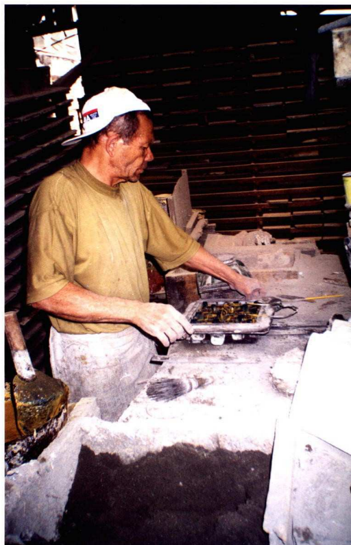
Figuras 8 – Mestre ajustando o molde dentro da fôrma. (Acervo pessoal).
