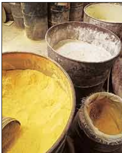
Figura 4 - O pó de mármore e outros pigmentos servem de base para a tinta. (MEDEIROS, 2003).
