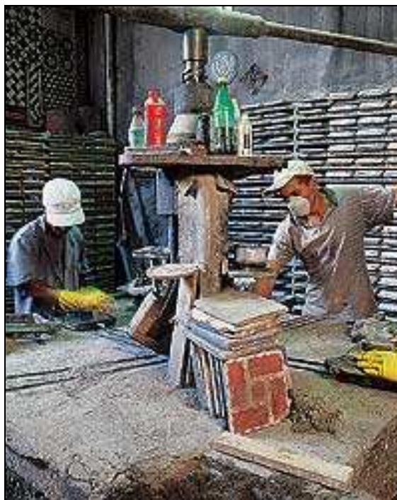
Figura 13 - A peça sendo prensada em uma prensa hidráulica. (MEDEIROS, 2003).
