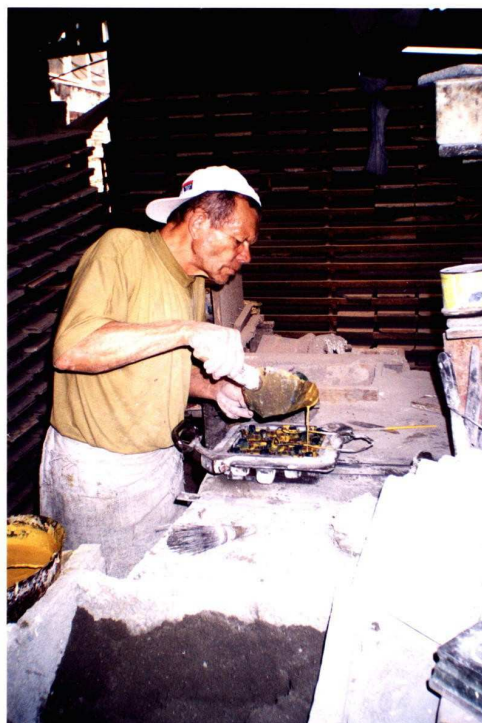
Figura 10 – Mestre ladrilheiro despejando a primeira camada sobre o molde. (Acervo pessoal).
