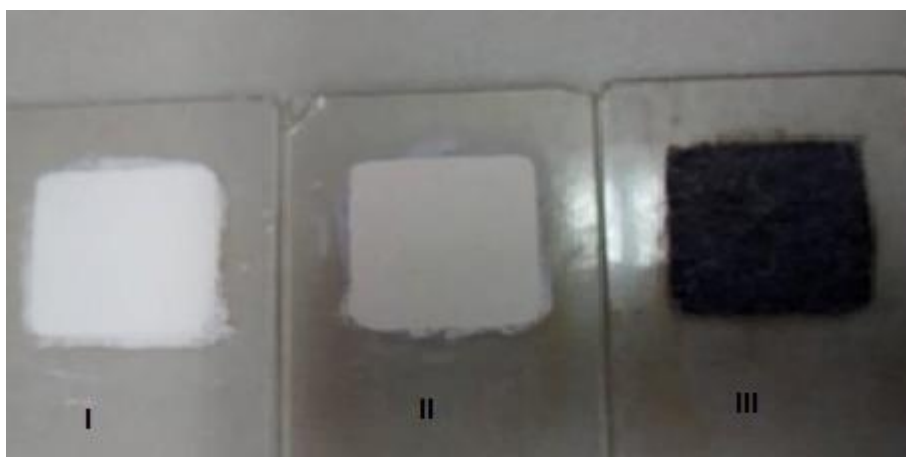
Figura 39 - Aspecto do catalisador antes de ser utilizado em reação (I), após um teste reacional preliminar (II) e após o teste de estabilidade a 375° C de 73h (III).
