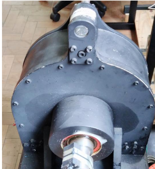
Figura 24 – Gerador Alxion 400STK2M .
