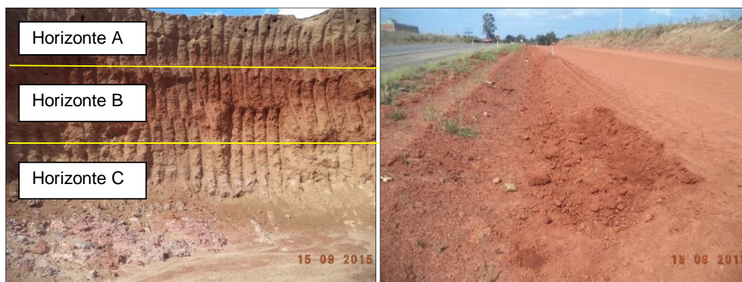
Figura 3.6 – Perfil da jazida Distrito Industrial e local coleta de solo (BR 287/RS)
