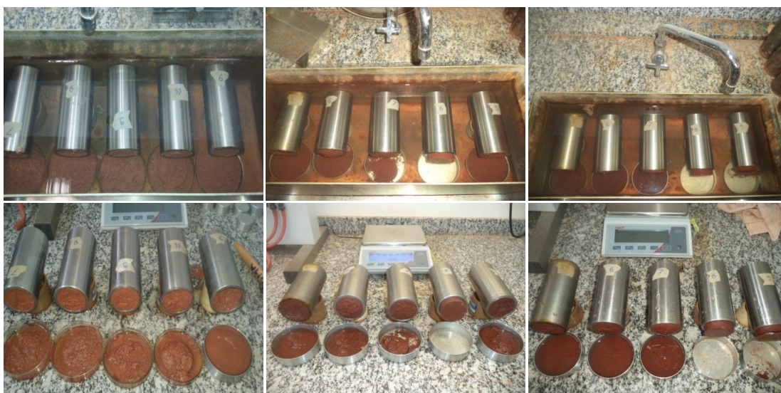
Figura 4.2 – Ensaio de perda por imersão dos solos
