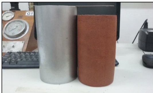
Figura 4.4 – CP após ensaio nº 9 ( \sigma_3 = 120 kPa e \sigma_d = 360 kPa) - solo CI
