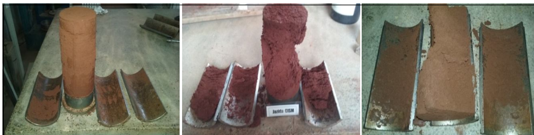
Figura 4.3 – CPs com excesso de umidade, não submetidos ao ensaio de M_R
