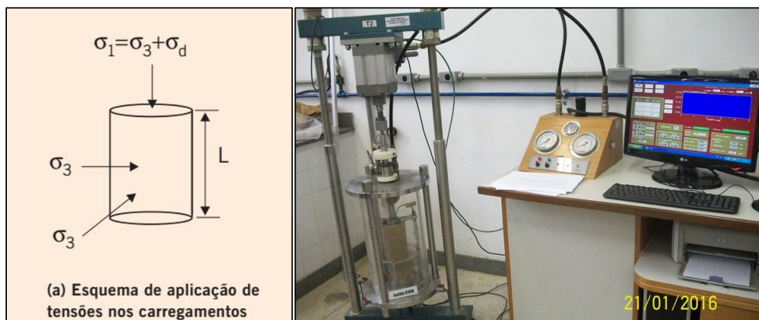
Figura 3.14 – Esquema de aplicação de carregamento e fotografia do equipamento triaxial de cargas repetidas da COPPE
