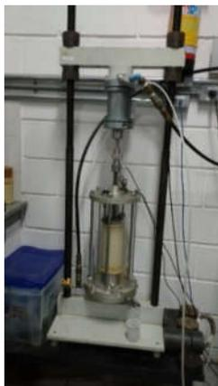
Santos (2016) relata que, na fase de condicionamento, o solo TR não resistiu ao último par de tensões (0,1029 – 0,309 MPa), optando-se por repetir o penúltimo par descrito em norma, para que assim fosse possível a realização do ensaio. Após os 600 ciclos dessa fase, o ensaio propriamente dito era automaticamente iniciado. Tendo em vista as características dos demais solos a serem ensaiados, optou-se por também repetir o penúltimo par de tensões na fase de condicionamento.
