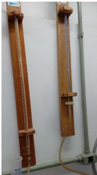
Após vedados, os corpos de prova foram conectados na mangueira e a bureta preenchida com água. As leituras foram realizadas na escala graduada (mm) e nos tempos 10, 20, 30, 40, 60, 80, 120, 240, 300 e 1440 minutos.
