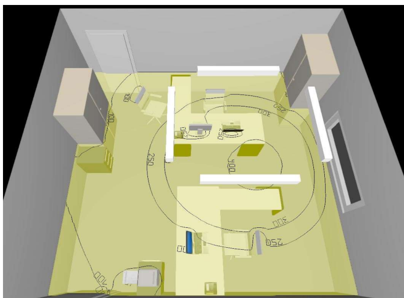
Figura 36 – Simulação do Sistema de Iluminação Atual
