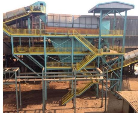
c) Peneira rotativa e moega coletora de terra e palha
