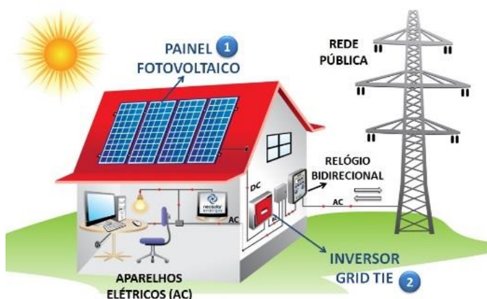
Figura 2.3 – Sistema Interligado de Microgeração de energia Fotovoltaica
