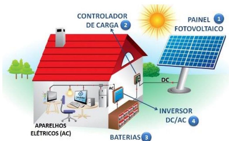
Figura 2.2 – Sistema Isolado de Microgeração de Energia Fotovoltaica
