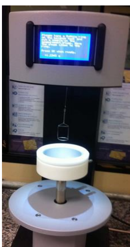
Figura 5 – Equipamento tensiômetro, responsável pelas leituras de tensão superficial de líquidos
